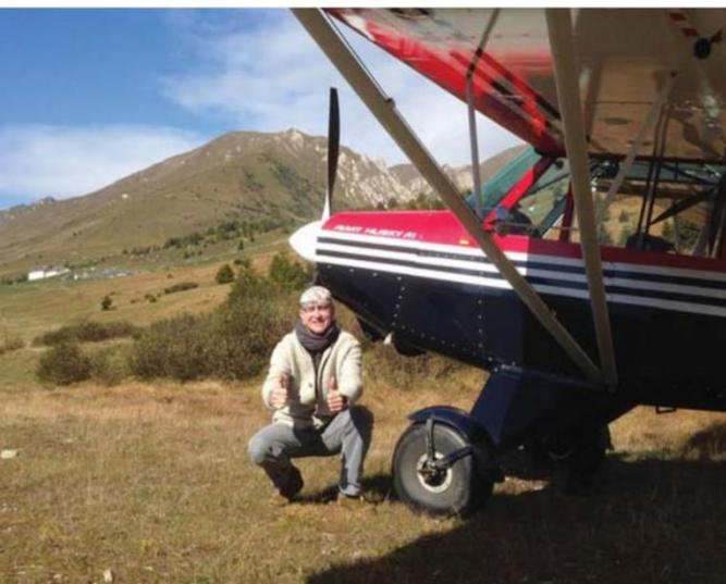
**L'Husky dispone** di ruote tundra con piccoli parafanghi di protezione dai sassi, può montare anche gli sci e i galleggianti per il volo idro
